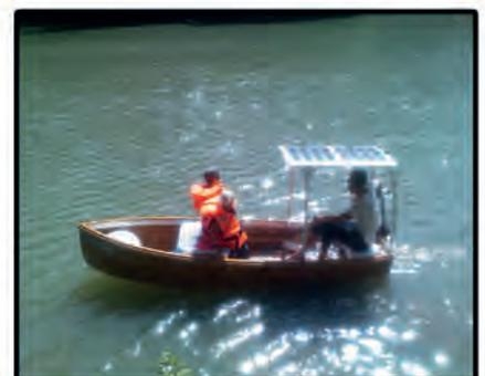
*Unser solarbetriebenes Boot wurde von Jugendlichen in der Bootswerkstatt von Job Ahoi gefertigt. Sonnenenergie wird durch die Solarpaneele am Dach des Bootes aufgenommen und in einem Akku gespeichert, der den Motor antreibt.*
